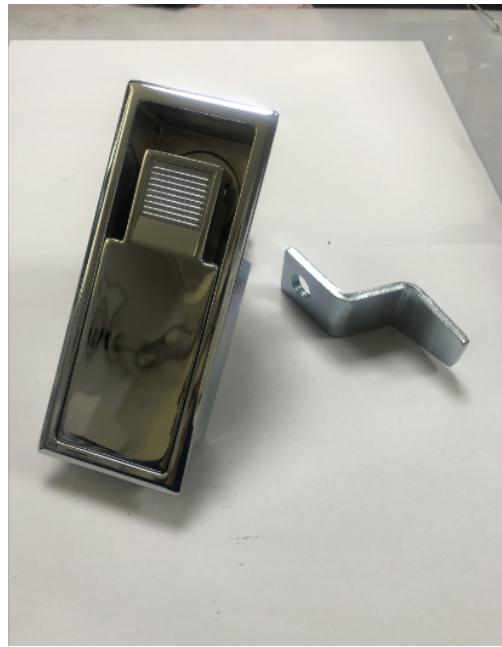
电柜门锁安装步骤：1、仔细阅读电柜门锁的说明书，然后用买来的门锁用纸或纸板制成的定距样板贴在门边适当的位置。2、选着孔锯的电钻，根据指定的大小给锁芯钻孔，钻尖要穿透门的另一面，然后在从门的另一面完成钻孔。3、然后在旁边钻一个大小合适的锁舌的孔，直至与锁芯孔相连。钻的过程中要保持钻尖与动力柜门成直角。然后用砂纸打磨孔的边缘。4、将锁舌插入孔中，然后固定。5、将锁舌与锁舌板插入用凿子凿出的榫眼中，并用螺钉交叉固定。6、插入外锁芯，是锁芯轴或连接杆适合锁舌组件，然后插入内锁芯，用螺钉固定。7、之后确定锁舌片的位置，并钻孔固定。
