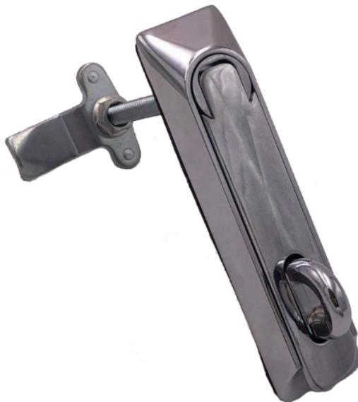
电柜门锁如何保养？有些人在电柜门锁出现发涩或发紧的时候，往往喜欢向锁眼里滴上一些润滑油，这样，电柜门锁很快就顺滑了，但因为油易黏灰，以后锁眼里会容易慢慢积存灰尘，而形成油腻子，这样反而使得电柜门锁更容易出现故障，因此，除非有必要，不然不要往锁眼里加润滑剂。可以削一些铅笔碎末或一些蜡烛碎末，通过细管吹入锁芯内部，然后插入钥匙反复转动数次即可。除了上面的保养方法以外，还要经常检查一下锁体与锁扣板之间的配合间隙，以及锁舌与锁扣板的高低配合和门与门框之间的间隙等等，如果这些配合不当，都需要做适宜的调整，否则就容易存在一定的安全隐患，甚至还会缩短锁具的使用寿命。带锁芯电柜门锁供应价格机械锁机械控制简单，成本低，外形构造小，轻便易带。
